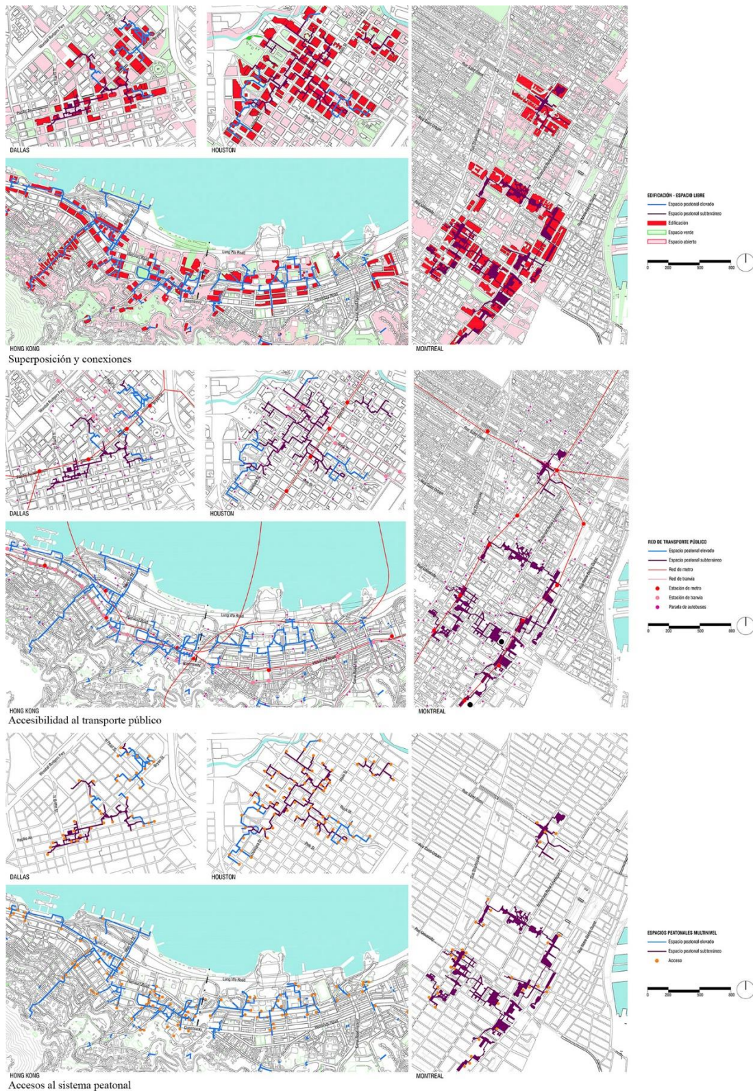
Figura 4. Superposición del sistema e interrelación con los edificios, espacios verdes y abiertos adyacentes; Ubicación de las paradas de autobuses, tranvía y metro; Localización de accesos a los espacios peatonales multinivel en el Nivel 0.
