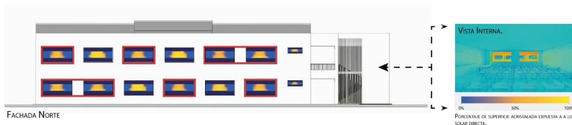
Figura 6: Análisis de confort lumínico fachada norte del bloque de aulas.
